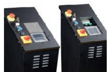
**Pupitre déportable** (en standard) à 1,50 m avec câble pour distinguer les fonctions de commande du mouvement machine.
