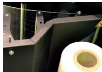
**Système anti-pincement de chargement du film** au sein du boîtier de pré-étirage.
