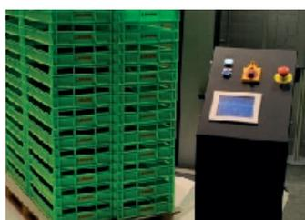
**Pupitre déportable** (en standard) à 1,50 m avec câble pour distinguer les fonctions de commande du mouvement machine.
